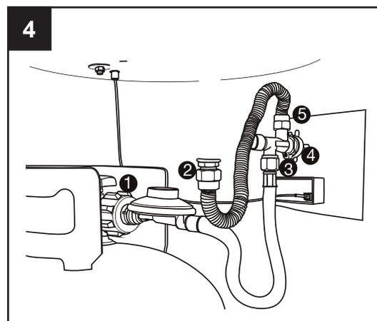
**REMARQUE :** Lorsque les raccords se desserrent, il faut refaire les tests d'étanchéité.
