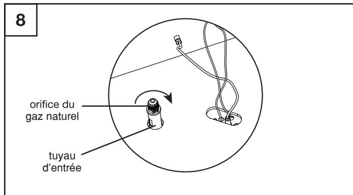
9. Brancher le tuyau ondulé à l'orifice de gaz naturel en serrant fermement avec la clé dans le sens des aiguilles d'une montre.
