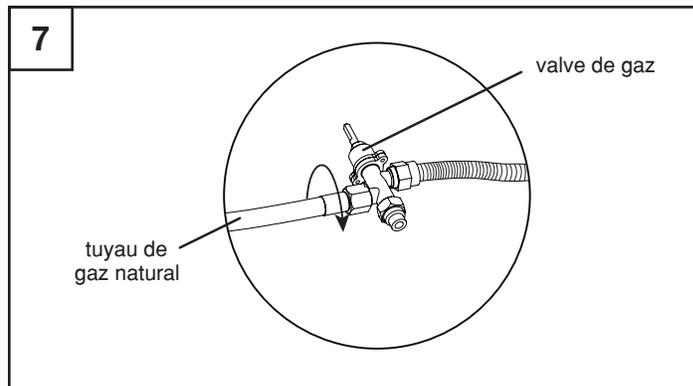
8. Brancher et serrer l'orifice de gaz naturel au tuyau d'entrée en utilisant la clé. L'orifice de gaz naturel (4,8 mm de diamètre) est marqué de noir.
